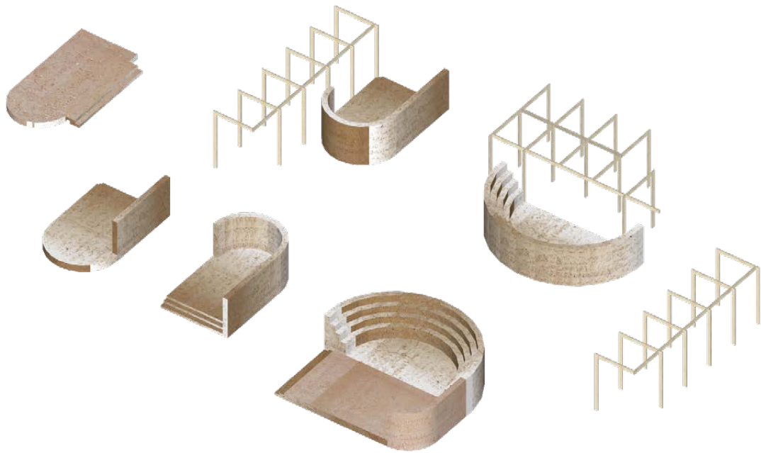
Esquisses, réalisation de plateformes d'activation de la Rurapolis en terre crue (pisé), pierre et bois
